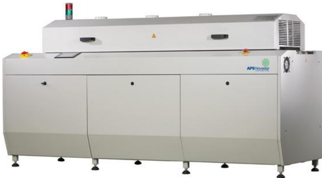
Obr 5: Průběžná pájecí pec [15]
