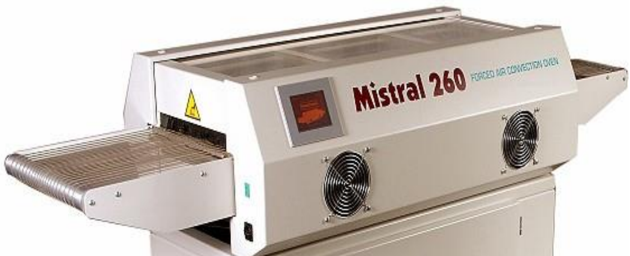
Obr 3: Průběžná infračervená pec [13]
